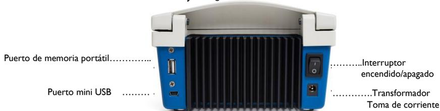
Conecte el transformador (**Fig. 7**) al cable de alimentación (**Fig. 2**) y luego a la parte posterior del lector PCRRun® (**Fig. 9**). Si el lector viene con un interruptor de encendido/apagado externo (**Fig. 3**), conéctelo a la parte posterior del lector PCRRun® y al cable del transformador. El transformador adaptará la tensión a 220 o 110.
